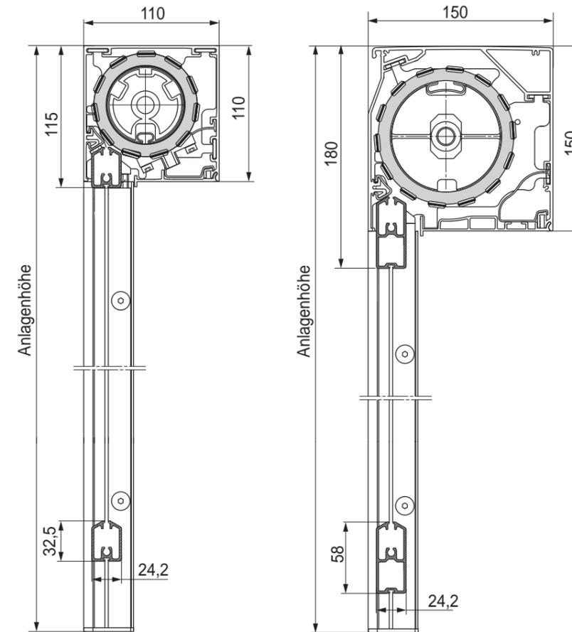
110 Millimeter Kassette mit Fallprofil Typ S
